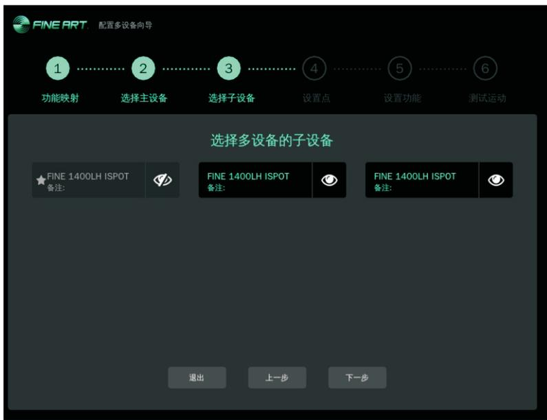
④设置点：在地面上选择一个点作为参考点，使每台灯都照射在参考点上，并且每台灯的光圈最大程度的重叠在一起。
