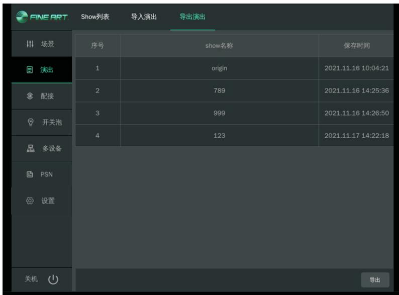
**9.3 配接功能：**可配置地址码与灯库。系统需配置与连接设备（带有摄像头的追光灯具或FINE ISPOUT EYE设备）相对应的灯库与地址码才可控制灯具。
