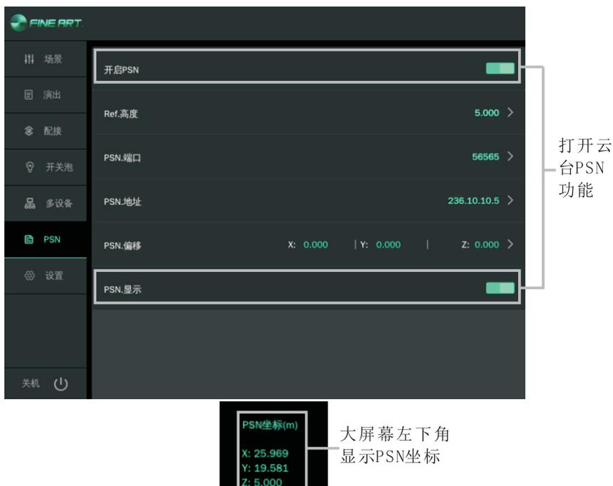
②. 在控台“Setup”中配置“PSN Network Configuration”功能。
