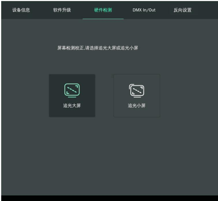
追光大屏检测校正：点击追光大屏后大触摸屏进入校正界面按提示点击屏幕四角。显示屏幕校正完成后点击退出即完成校正。
