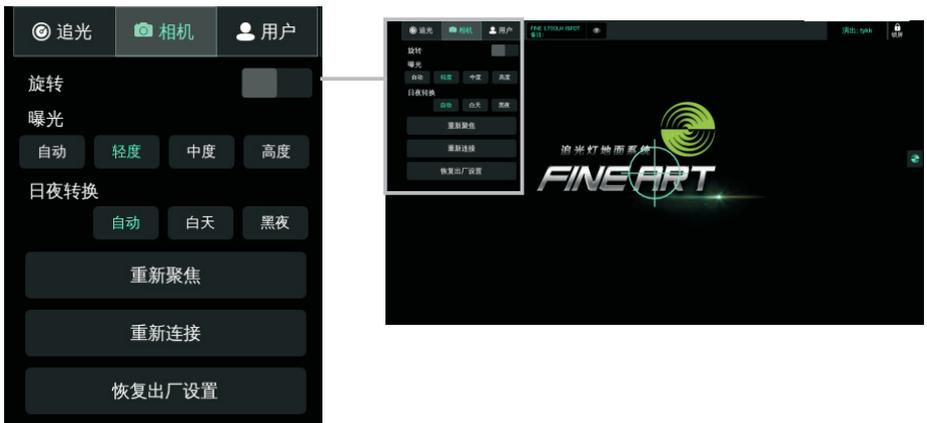
**旋转：**控制摄像机显示的旋转角度正向或反向的显示；
