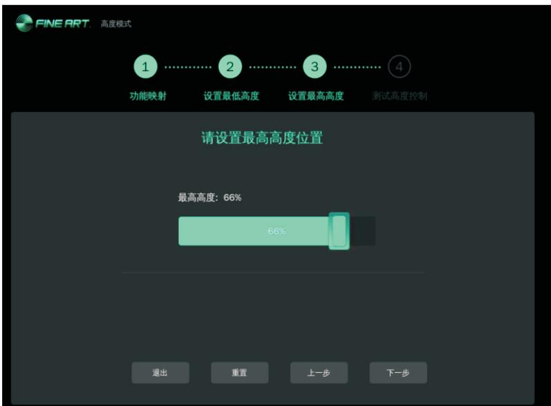
整好最低值和最高值后，需要进行测试，看现场测试结果，高度不合适就重新调整。高度合适，点击保存。
