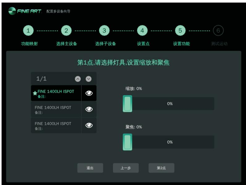
⑥测试运动：可摇动手柄测试，在屏幕中查看灯具校准的情况，如果不满意校准的效果，可点击“重新采样”重新进行设置。效果满意可以保存后退出。
