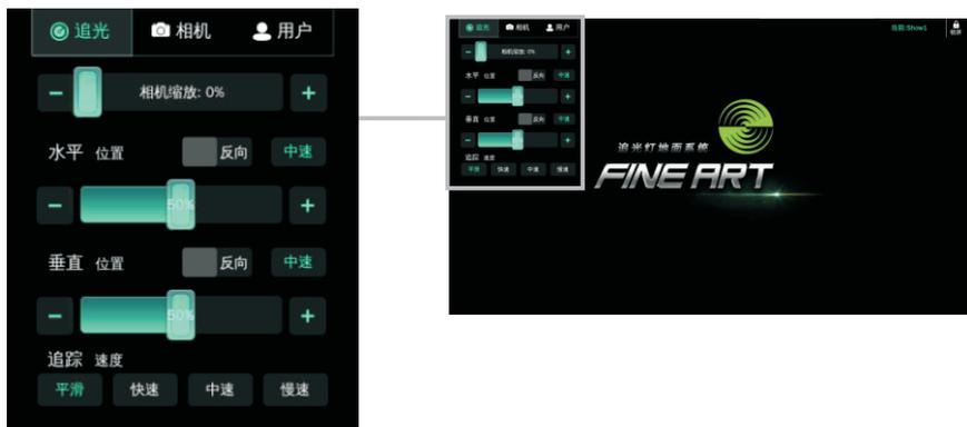
**变焦缩放：**可设置摄像头的缩放范围，左右“-/+”按键可以微调摄像头的焦距；焦距调节设定后，摄像头将自动完成对焦。
