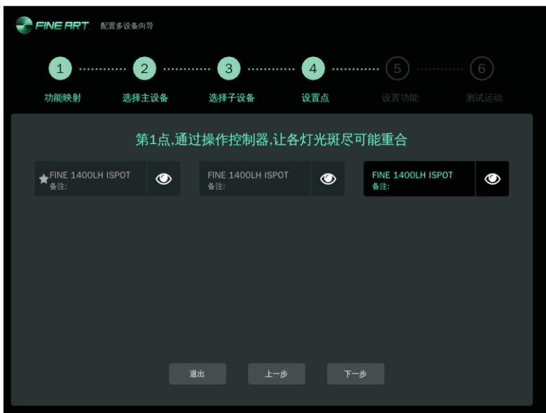
⑤设置功能：灯光光束都重叠后需调整每个灯的缩放和聚焦，多灯设置最少要调校2个点，最多可调校5个点。设置完点后点“执行”，进行下一步操作。
