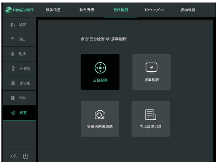
云台检测：可测试滚轮、按键、扶手XY轴转动、推杆是否运作。“测试所有LED”为小触摸屏四个按键LED的亮度测试。“测试手柄”为测试扶手上下左右移动是否正常。“测试网口”为测试网口是否存在。检测到运作则界面相应区域呈绿色显示。
